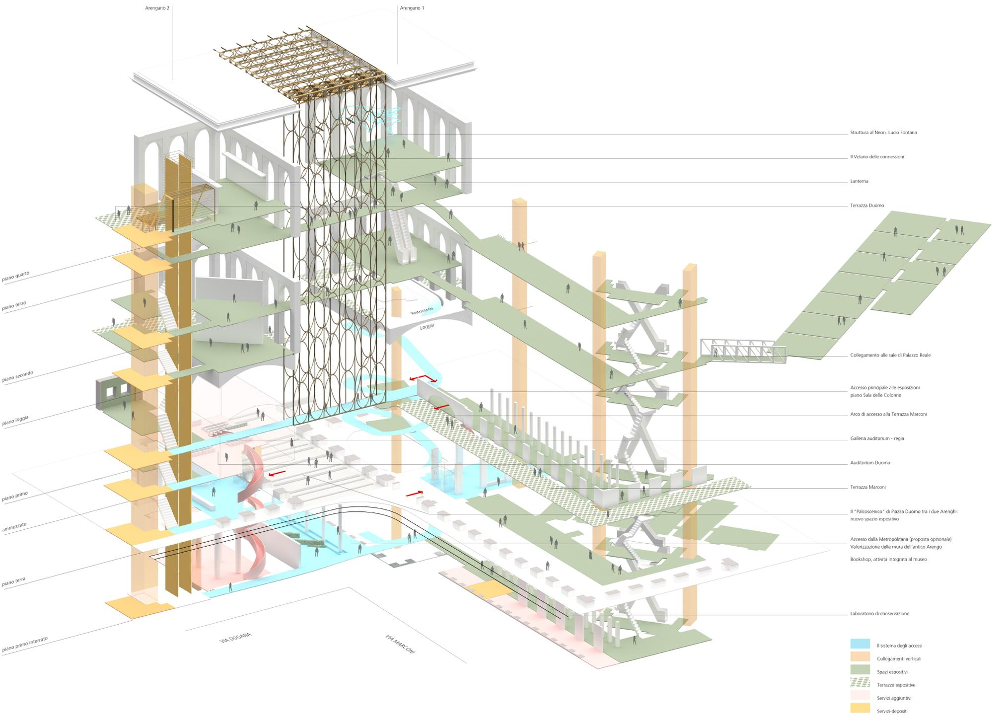
Schema assonometrico della distribuzione e delle connessioni tra i due Arenghi
