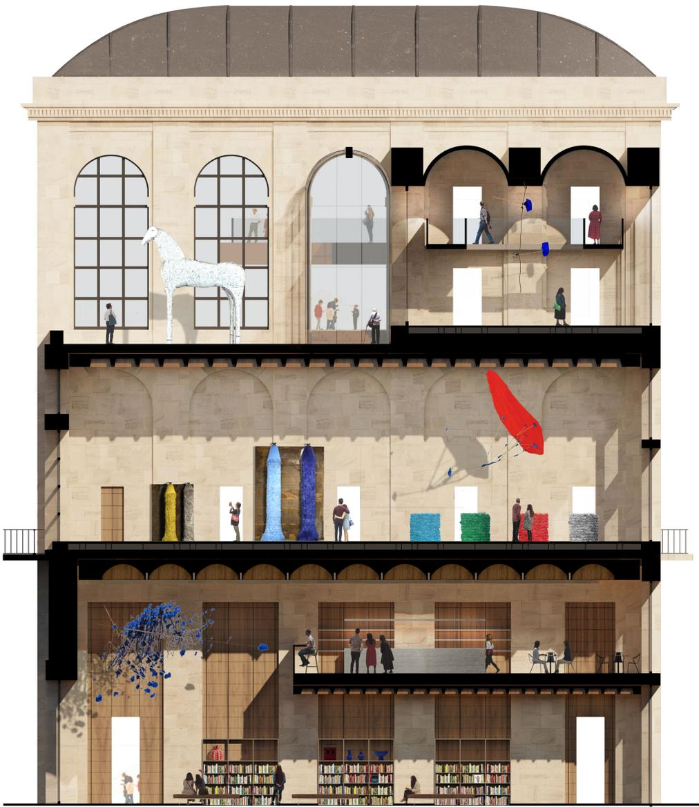
SEZIONE LONGITUDINALE SUL CORPO DI COLLEGAMENTO DEL SECONDO ARENGARIO CON PALAZZO MENGONI
