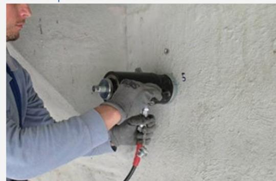
PROVA PULL-OUT. Esempio di ricerca non invasiva per l’analisi strutturale del c.a.
