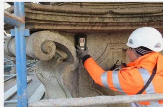
PROVE ULTRASONICHE. La propagazione di onde elastiche longitudinali determina la omogeneità materiale.
