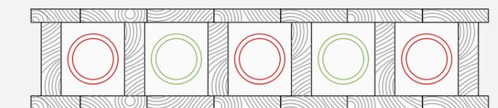
LASTRE CLT vuoti consentono pre-installare i condotti impiantistici. Le cavità sono riempite con lana di roccia per l'isolamento termico e acustico. (Vedere il capitolo sulla Sostenibilità.)
