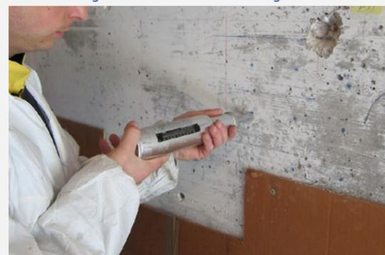
PROVA SCLEROMETRICA. Per determinare la durezza superficiale del materiale.
