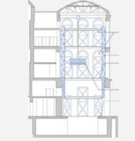
**12** Per assicurare la protezione di tutte le componenti storiche, i lavori di costruzione avverranno senza bisogno di coinvolgere le facciate originarie ed il tetto dell'edificio. Posizionando un carroponte all'interno, la struttura verrà rinforzata, e i solai originari verranno sostituiti con piastre leggere in legno x-lam, aumentando così la resistenza sismica dell'edificio. Il vuoto e l'auditorium dell'Arengo saranno le ultime parti ad essere costruite, e le prime ad aprire al pubblico.
