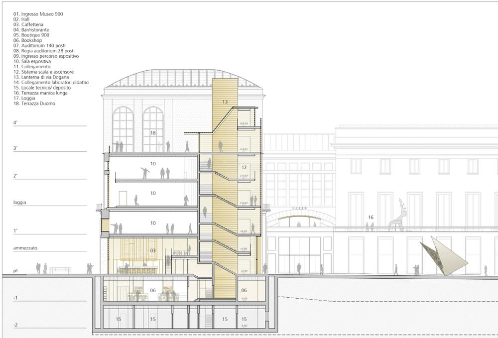
Sezione DD, secondo Arengario - la lanterna di via Dogana, il sistema dei collegamenti verticali
