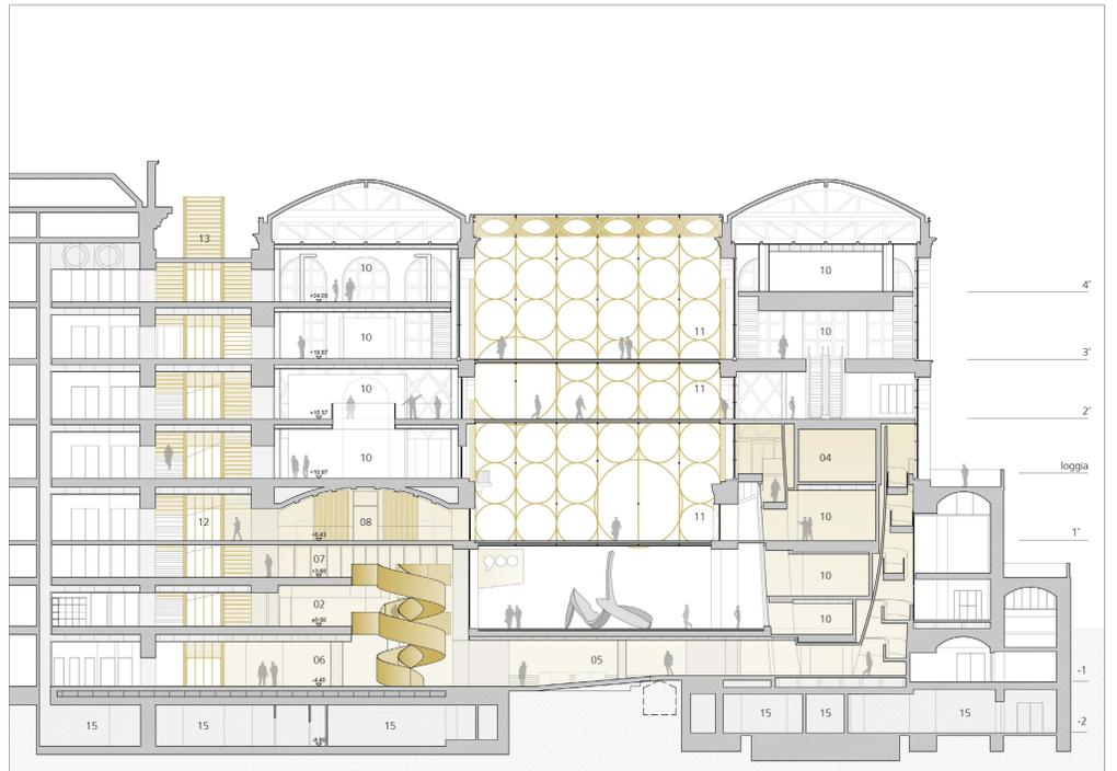
Sezione CC - il sistema delle connessioni fra i due Arengari
